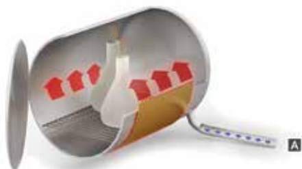
Камера автоклава нагревается внешней нагревательной пластиной, обеспечивая эффективную теплопередачу в условиях вакуума
